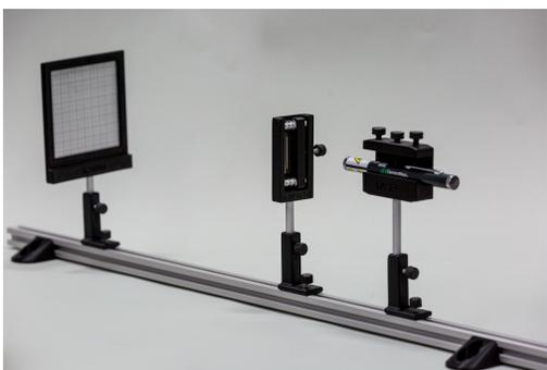
Abbildung 4: Versuchsaufbau mit verstellbarem Einzelspalt
