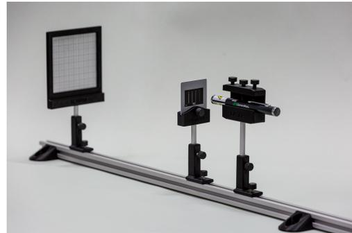
**Abbildung 1:** Aufbau der Optikbank mit Mehrfachspalten auf selbstgedrucktem Dia
