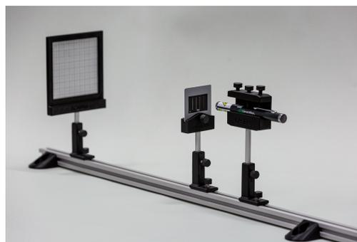
Abbildung 6: Versuchsaufbau mit Beugungsobjekt auf Dia
