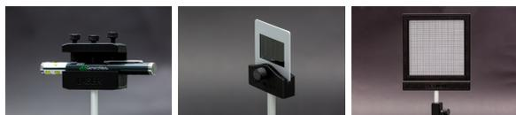
Abbildung 3: Halterungen für Laserpointer, Dia und Schirm
