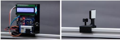
**Abbildung 2:** Sende-/Empfangseinheit und Reflektor in Detailansicht
